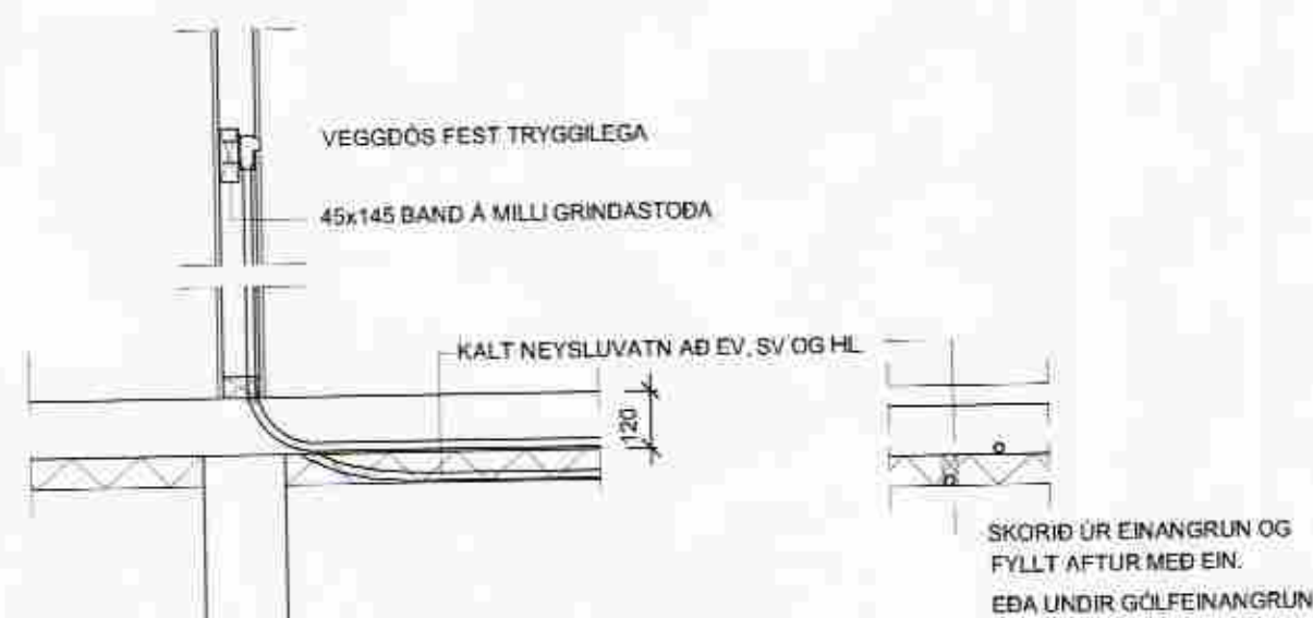
SÉRMYND-A DÆMIGERÐUR FRÁGANGUR VIÐ DÓS Í LÉTTUM INNVEGG
